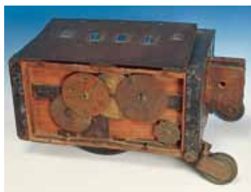
量程車 動輪の回転数を歯車で数え、距離を測る。（千葉・伊能忠敬記念館蔵）
